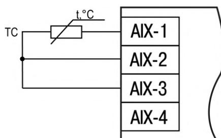
Рисунок 5.18 – Схема подключения ТС по трехпроводной схеме
