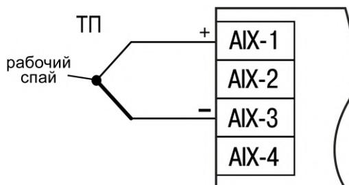
Рисунок 5.19 – Схема подключения ТП
