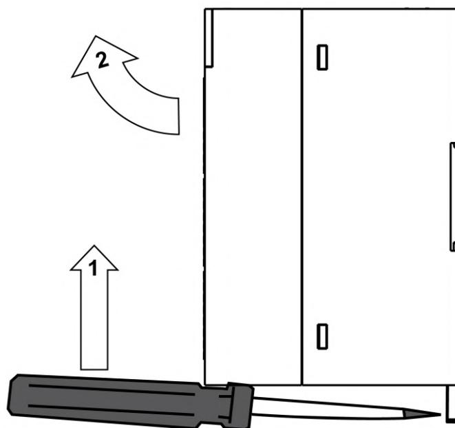
Рисунок 4.5 – Демонтаж прибора с DIN-рейки
