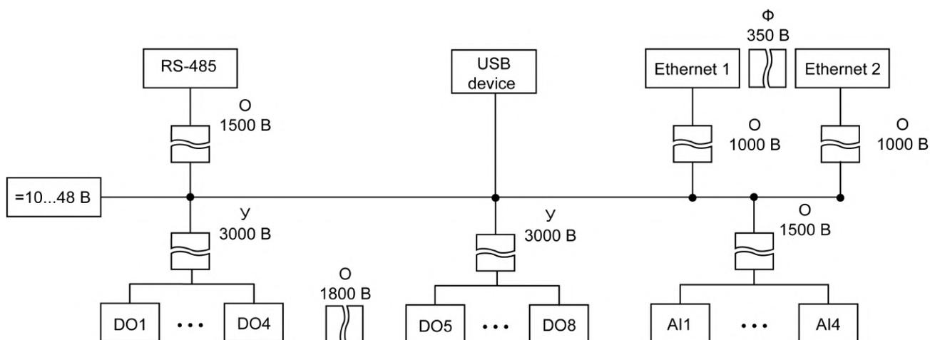
Рисунок 2.4 – Схема электрической прочности изоляции ПЛК200-04
