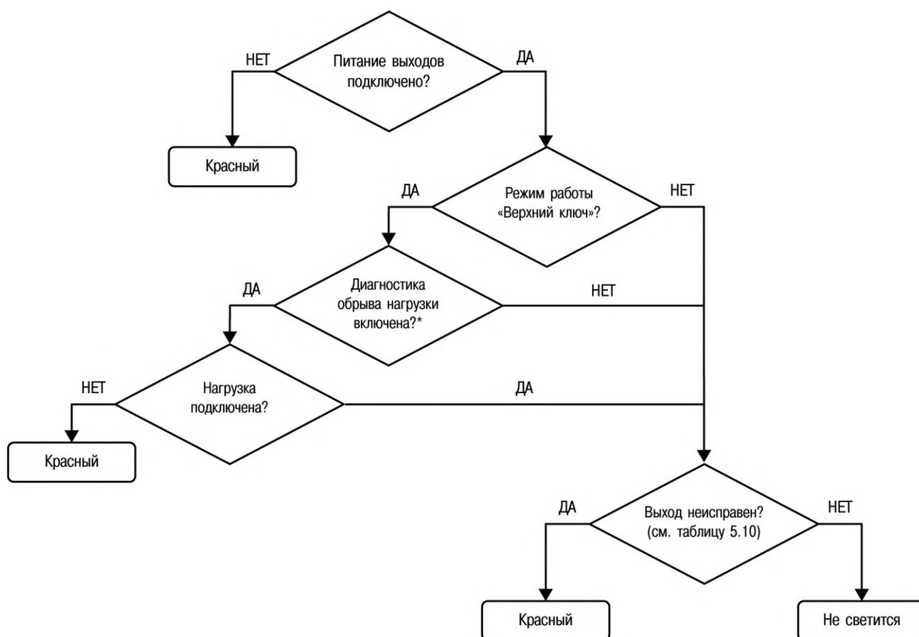
Рисунок 5.17 – Схема для определения цвета индикатора транзисторных выходов
