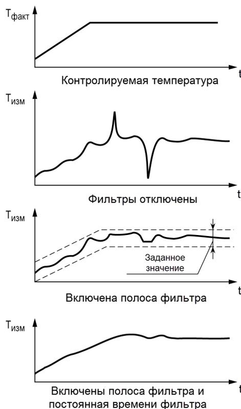
**Рисунок 5.25 – Временные диаграммы работы цифровых фильтров**
