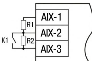
Рисунок 5.24 – Схема подключения датчика типа «сухой контакт»
