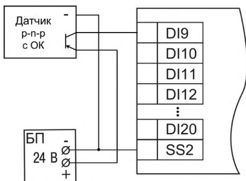
Рисунок 5.10 – Подключение транзисторов типа p-n-p DI9–DI20
