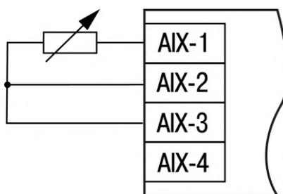
Рисунок 5.23 – Схема подключения датчиков типа 0...2 кОм и 0...5 кОм
