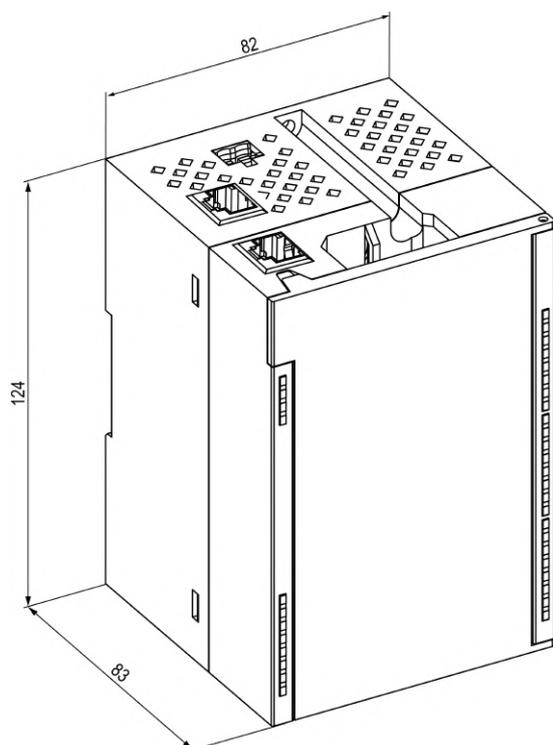
Рисунок 4.3 – Габаритный чертеж
