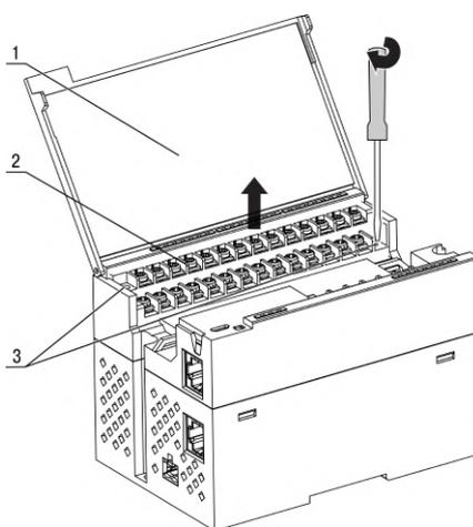
**Рисунок 3.7 – Снятие первой клеммной колодки контроллера**
