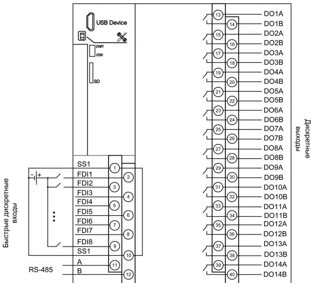
Рисунок 5.2 – Назначение контактов клеммника (модификация 01)
