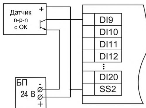
Рисунок 5.11 – Подключение транзисторов типа n-p-n DI9–DI20
