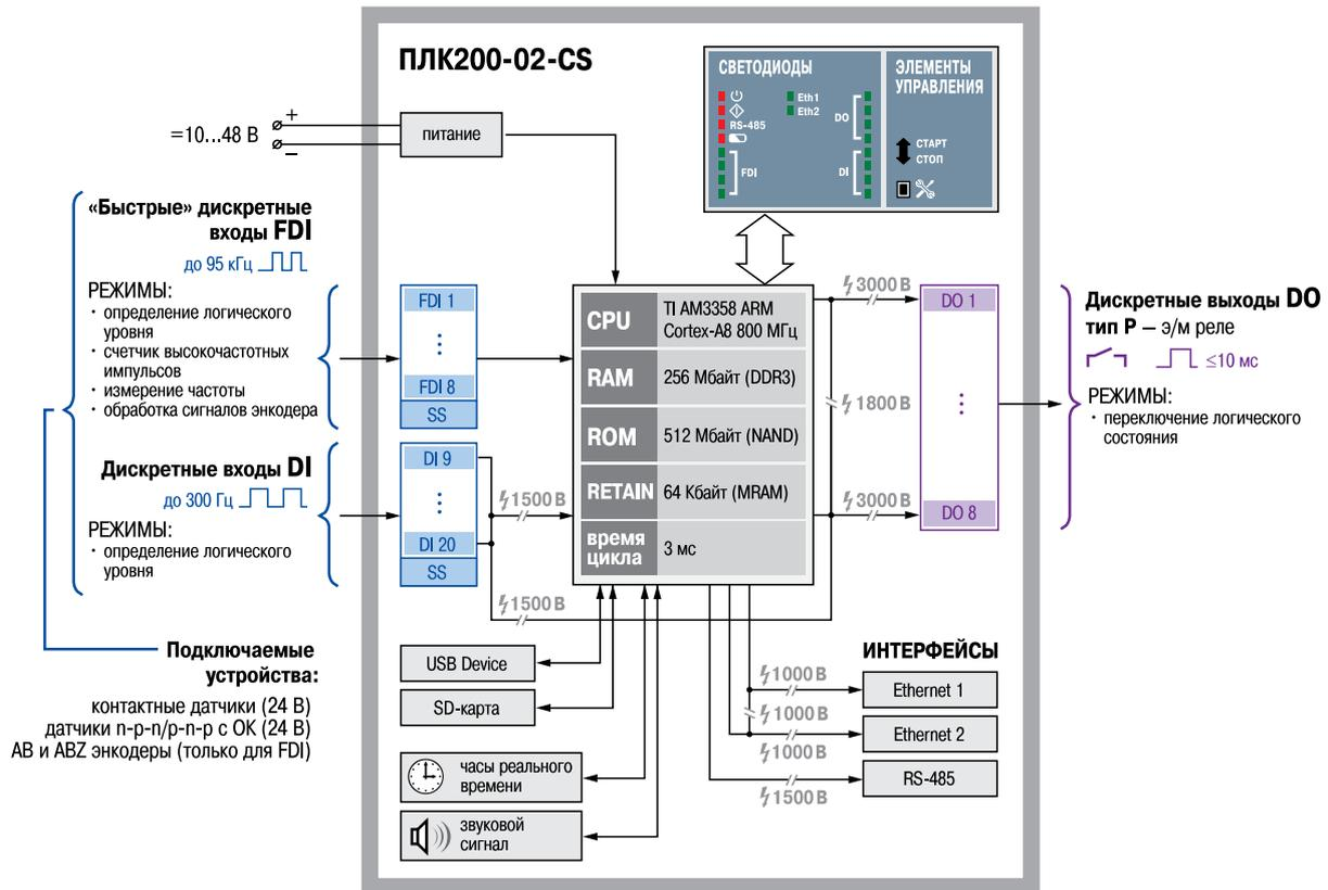
Рисунок 3.2 – Функциональная схема ПЛК200-02-CS
