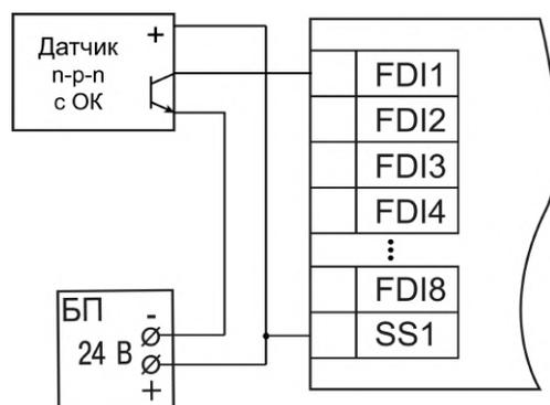
Рисунок 5.9 – Подключение транзисторов типа n-p-n\* FDI1–FDI8
