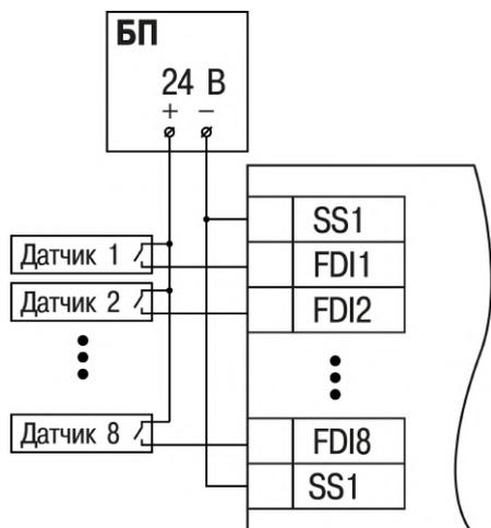
**Рисунок 5.6 – Схема подключения контактных датчиков к быстрым дискретным входам FDI1-FDI8**
