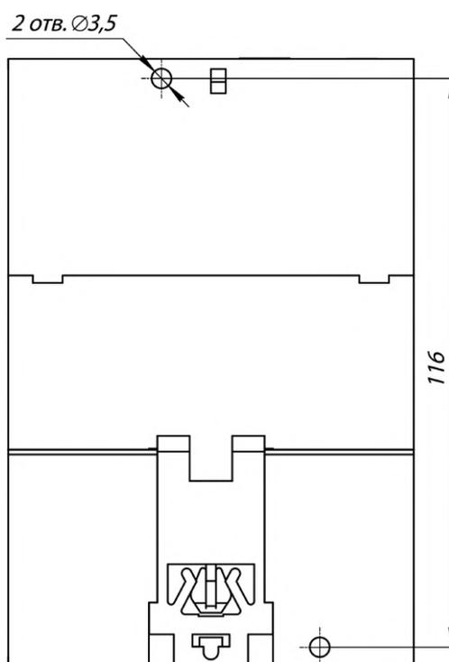
Рисунок 4.4 – Установочные размеры
