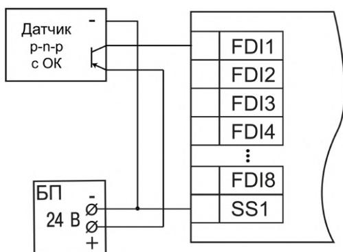
Рисунок 5.8 – Подключение транзисторов типа p-n-p FDI1–FDI8
