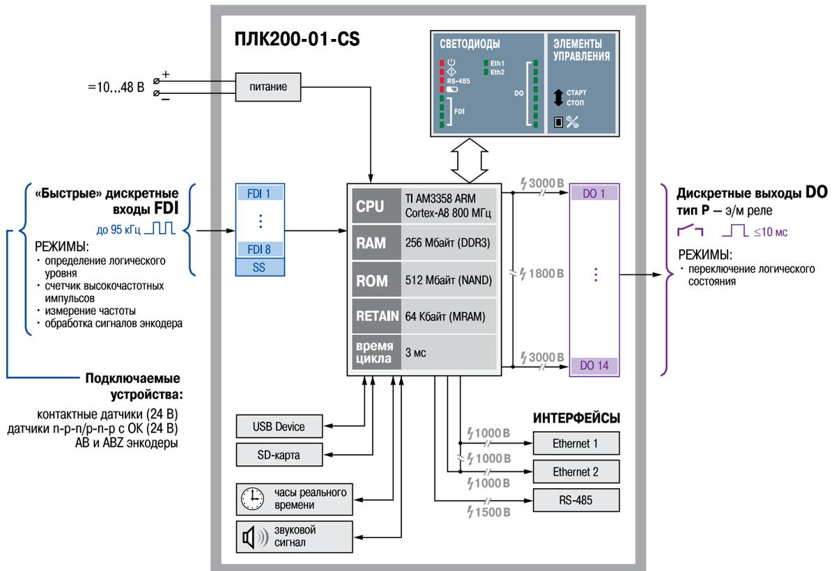
Рисунок 3.1 – Функциональная схема ПЛК200-01-CS
